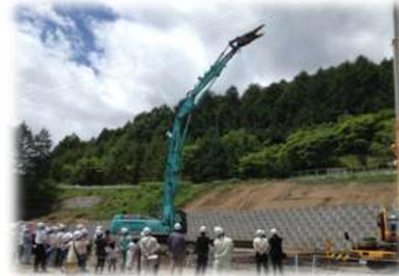
高いところの解体工事に使用した重機を動かしました。この重機は18mの高さまで、届きます。
